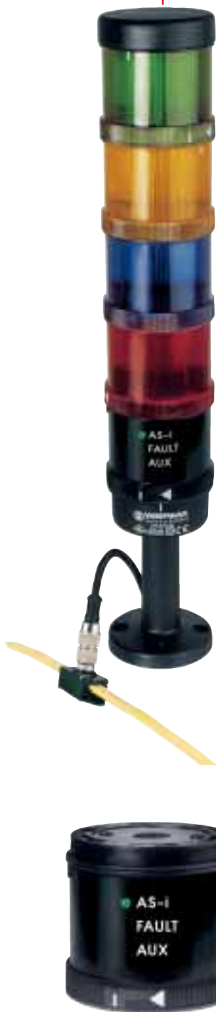
Valodiodei näyttää elementin toimintatilan.
