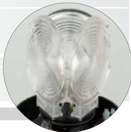
Kolme Fresnel-linssiä ovat 120°:n kulmassa
